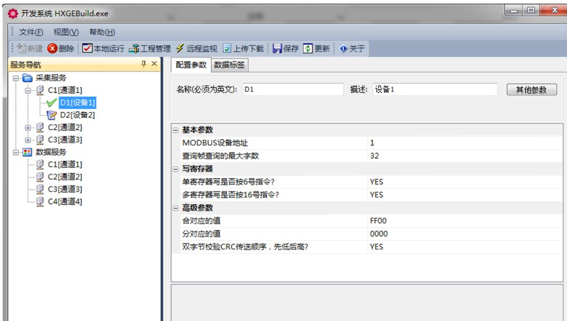
一个网关的采集服务，通常包含 1 个或者 n 通道，每个通道独立运行，互不干扰；每个通道下面又包含若干设备，每个设备和现场实际相对应，比如一个温度控制器，一个电量表，或者一个工业使用的 PLC；每个设备下面又包含若干数据标签，设备标签是数据的最小单元，每个数据标签对应一个实际的参数，比如温度值、电压值等；采集软件运行后，采集调度会对同一通道下的所有设备进行轮询式的扫描，即采集完设备地址为 1 的设备后，紧接着会采集设备地址为 2 的设备，直至采集完所有的设备，则完成一个轮回，数据就这样周而复始的被调度轮流采集。
