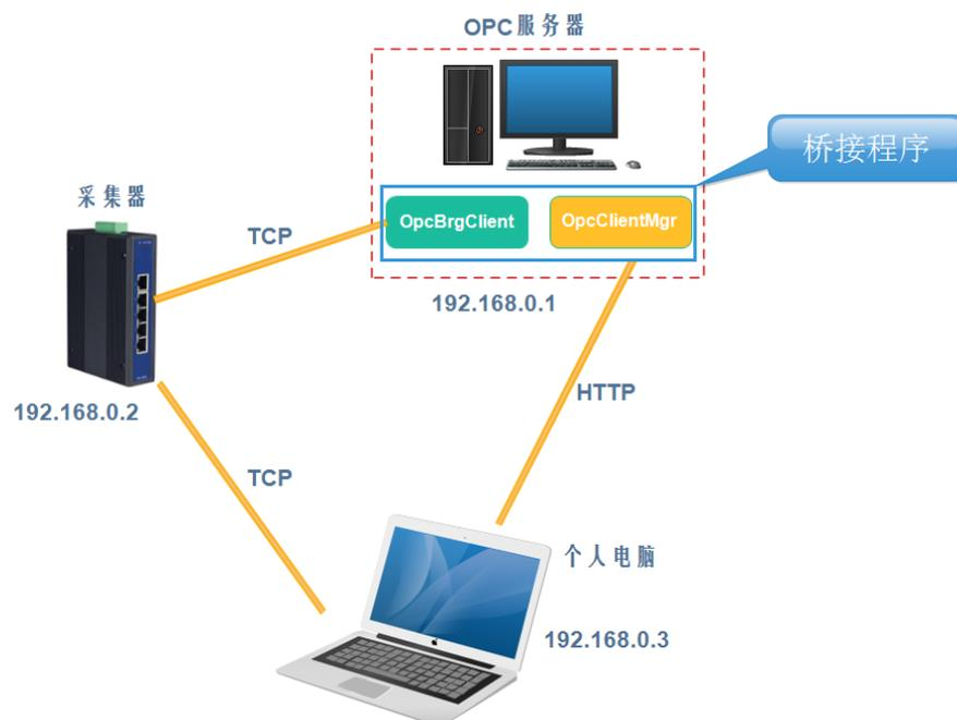
如上图所示为一个常用 OPC 桥接程序的拓扑架构，最终目标是采集器网关获取到 OPC 服务器的数据。其中服务器运行两个程序，一个是 OpcClientMgr.exe，另一个是 OpcClientBridge.exe。OpcClientBridge.exe 用来获取本地 OPC SERVER 数据，并通过 TCP 把数据送至采集器；OpcClientMgr.exe 用来看护 OpcClientBridge.exe 的运行，另一方面提供 HTTP 服务，用来响应个人电脑配置所需要的服务；双击 OpcClientMgr.exe 后，即可自动把 OpcClientBridge.exe 启动起来；个人电脑配置完工程后，一方面要把配置传送至采集器，另一方面需要送至 OPC 服务器，以确保采集器和服务器的配置是一样的，才能保证服务器和采集器的数据严格同步。
